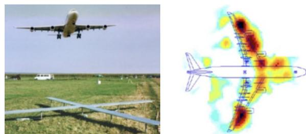
Figure 8 : Identification de sources acoustiques en vol par antenne focalisée
