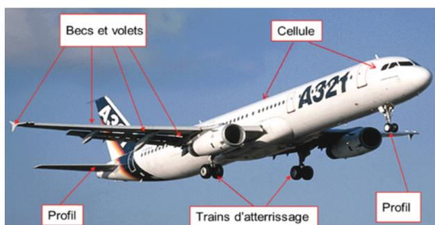
Figure 5 : Sources de bruit d'origine aérodynamique
