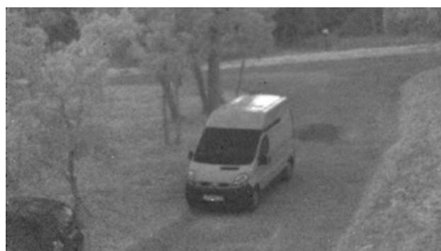
*Scène mesurée dans la bande spectrale 1,4 - 1,8 µm par une nuit sans lune*
