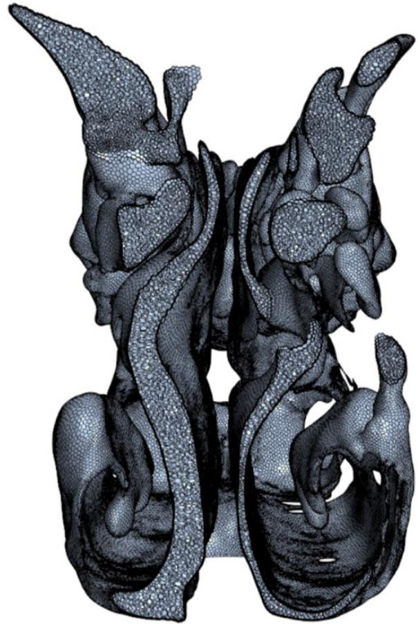
Figure 6. Coupe au sein du domaine de calcul après maillage volumique montrant les éléments constitutants
