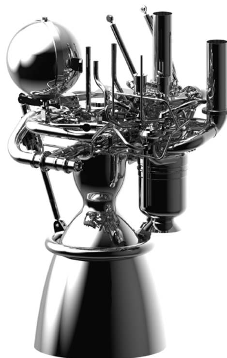
Moteur Prometheus – Oxygène liquide / Méthane liquide, réutilisable
