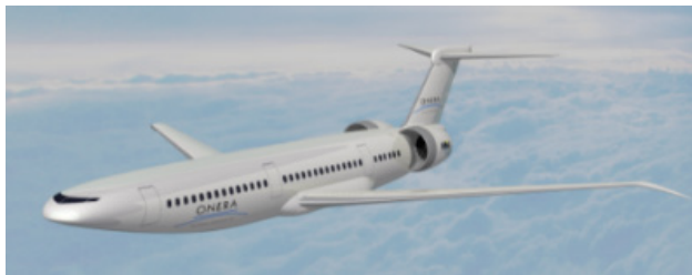
NOVA : exemple d'installation motrice semi-enterrée
