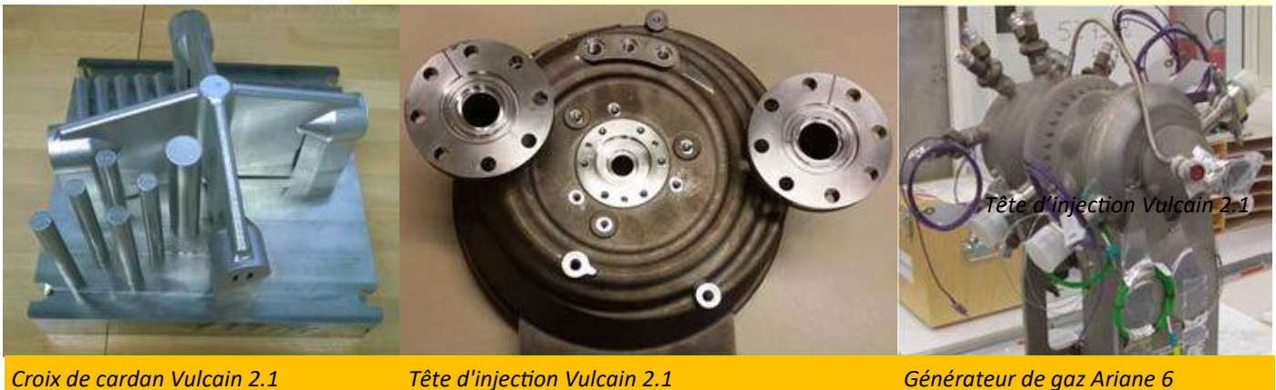
Fig. 3 - Réalisations d'Ariane Group par fabrication directe pour ensembles propulsifs
