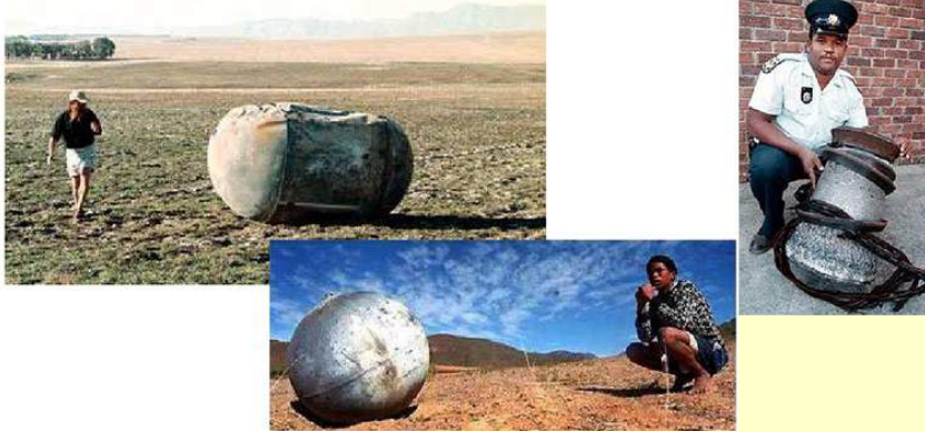
Fig. 2 - Fragments d'un second étage de Delta2 retrouvés au sol
