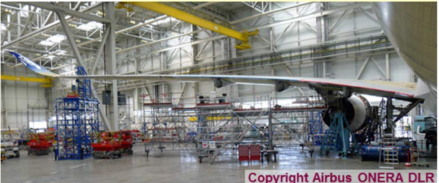
Fig. 4 - Essais de vibration de l'A350 en avril 2014.
