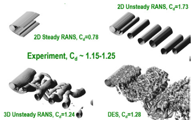
Figure 6. Ecoulement autour d'un cylindre 2D. Simulation par approches 1) RANS 2D stationnaire, 2) RANS 2D instationnaire, 3) RANS 3D instationnaire, et 4) DES. Avec la permission de NTS.
