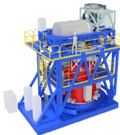
Figure 5.2 : L'instrument HARMONI 10x5x8 m3, 35 tonnes. Spectro-Imageur de première lumière de l'ELT. Instrument à haute résolution spatiale et spectrale. Il intègre 2 systèmes d'OA (dont un tomographique Laser fonctionnant avec 6 étoiles artificielles) et un imageur hyper-spectral fonctionnant dans le visible et dans l'Infra-Rouge (de 0.45 à 2.2 microns) qui allie résolution spatiale (jusqu'à des pixels de 4 millisecondes d'arc) et spectrale (avec une résolution pouvant évoluer entre 3000 et 20000 selon les besoins)
