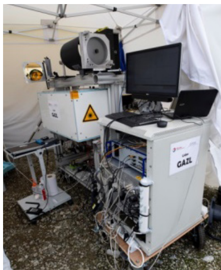
Figure 5 : Lidar GAZL déployé sur le terrain lors d'une campagne de mesure en 2018 (à gauche) et visualisation d'une mesure de panache d'un rejet contrôlé de méthane pour tester le dispositif (à droite), avec en abscisse le temps et en ordonnée la distance par rapport au lidar ; la concentration en méthane sur l'axe de visée en fonction de la distance est indiquée en couleurs (DPHY, 2018).
