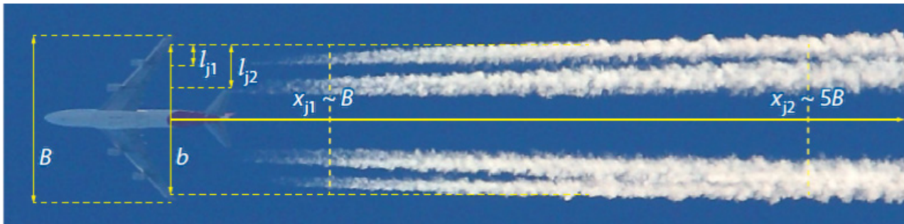
Figure 3: Localisation du début d'interaction entre le tourbillon de bout d'aile et le moteur externe ( x_{j1} ) et entre le tourbillon de bout d'aile et le moteur interne ( x_{j2} ). Selon la formule de Jacquin et Garnier (1996) pour un avion de ligne de type quadriréacteur et d'envergure B . L'interaction entre le tourbillon marginal et le moteur externe débute à une envergure ( B ) derrière l'avion et l'interaction entre le tourbillon marginal et le moteur interne débute à cinq envergures derrière l'avion ( 5B ). Photographie provenant de Wikipédia, copyright Firooo2/Flagstaffotos.
