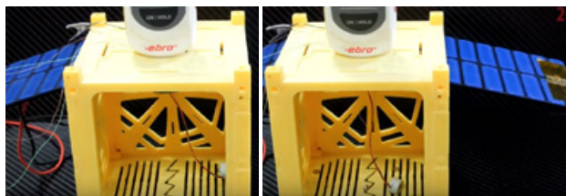
Figure 6 : Déploiement d'un panneau solaire d'un Cubesat 1U par un Triggy @Nimesis
