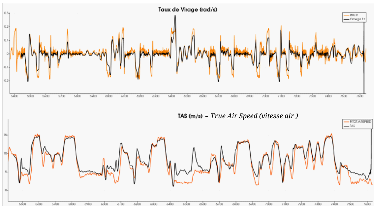
Figure 2. Modèle dynamique de résolution de la dynamique de vol. La courbe orange représente les données d'essais en vol, la courbe noire le résultat de la simulation
