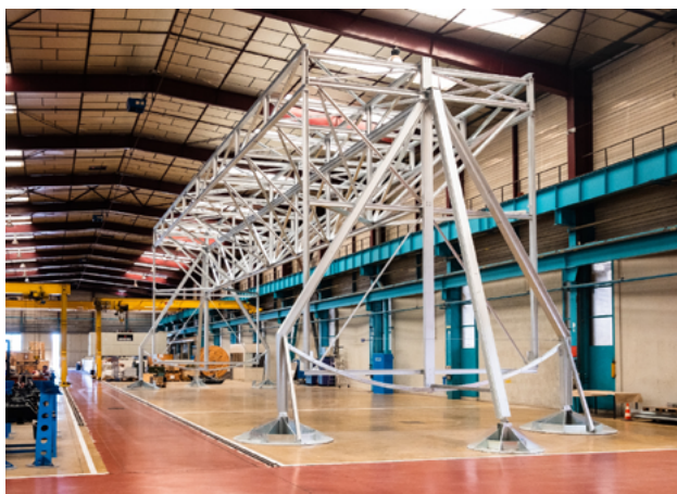
Figure 5. Outillage d'essai de la maquette gondole de 27 m de long
