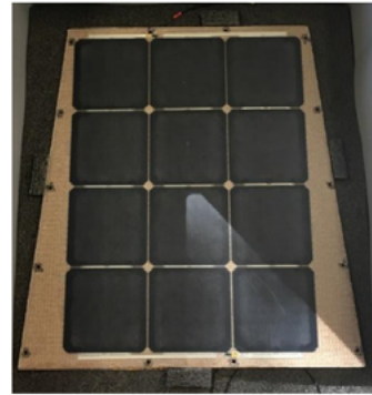
Panneau en composite nid d'abeille d'épaisseur 4 mm avec inserts de fixation
