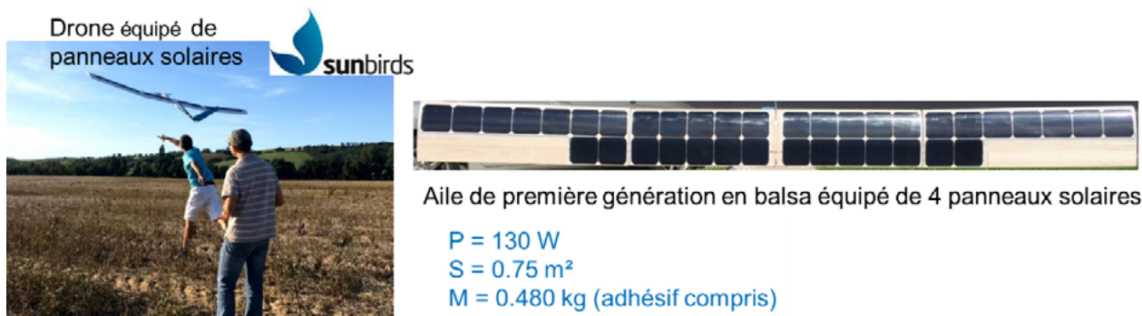
Figure 3. Prototype de drone solaire Sunbirds pendant sa phase de développement et aile avec ses panneaux solaires et principales caractéristiques des panneaux
