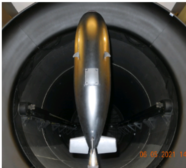
Essais en soufflerie de la maquette LCAT
