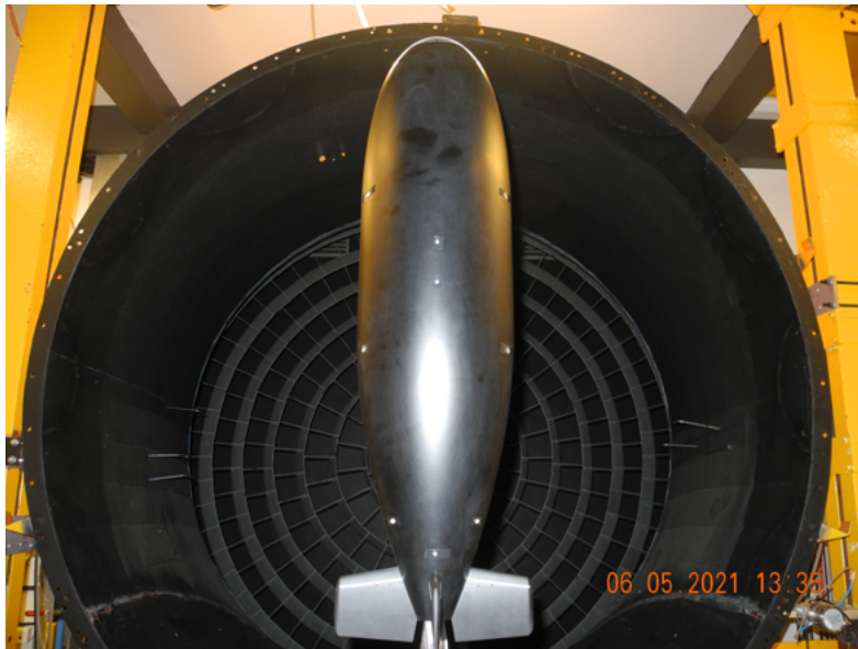
Maquette d'une configuration de LCA60T (Flying Whales) en soufflerie L1 à l'ONERA-Lille sur montage « pqr » - Nouvelle Configuration 2020
