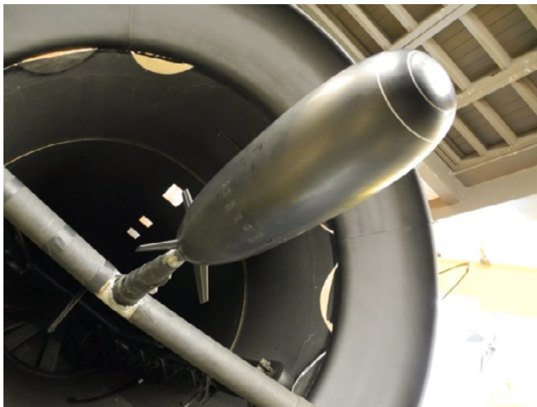
Maquette d'une configuration de Stratobus en soufflerie L1 à l'ONERA-Lille sur montage « pqr » - Nouvelle Configuration 2019
