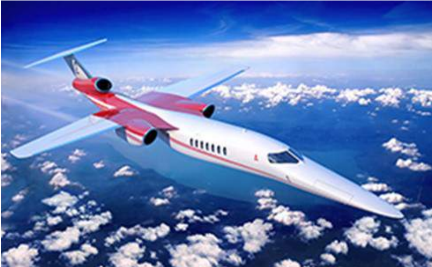
Fig. 7 - Dernier projet AS2 d'Aerion ; 4200nm (7700km) à Mach 1.4, masse au décollage de 60.3 tonnes.
