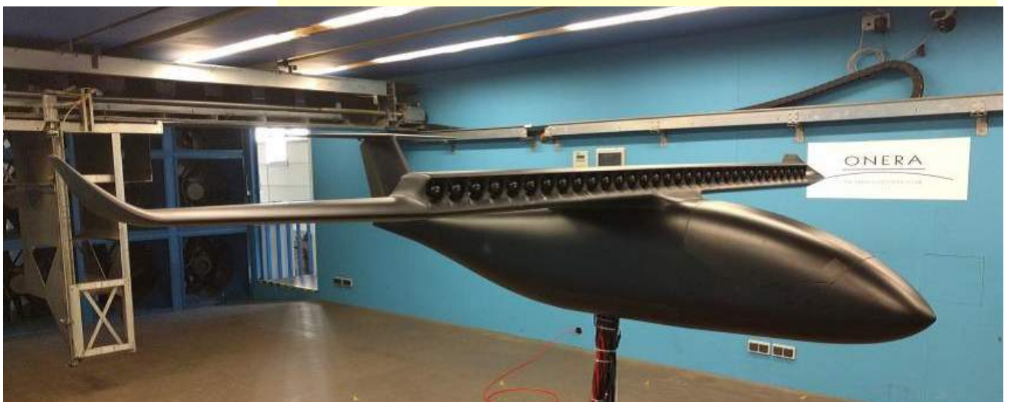
Fig. 6 - La maquette AMPERE dans la soufflerie L2 de Lille.
