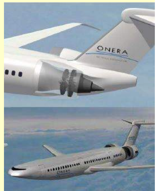
Fig. 4 - Concept ONERA NOVA (NextGen Onera Versatile Aircraft) pour aller plus loin en termes d'économie de carburant, d'émissions polluantes et de bruit ; parmi les innovations de rupture, on prévoit l'ingestion de la couche limite au niveau des moteurs.
