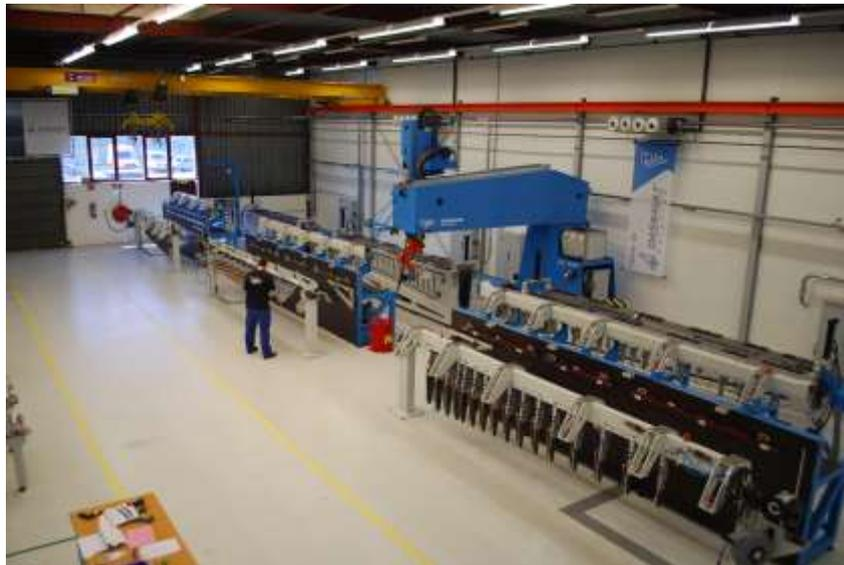
Production de gouvernes de profondeur et de direction soudées par induction (Source : FOKKER / GKN Aerospace)
