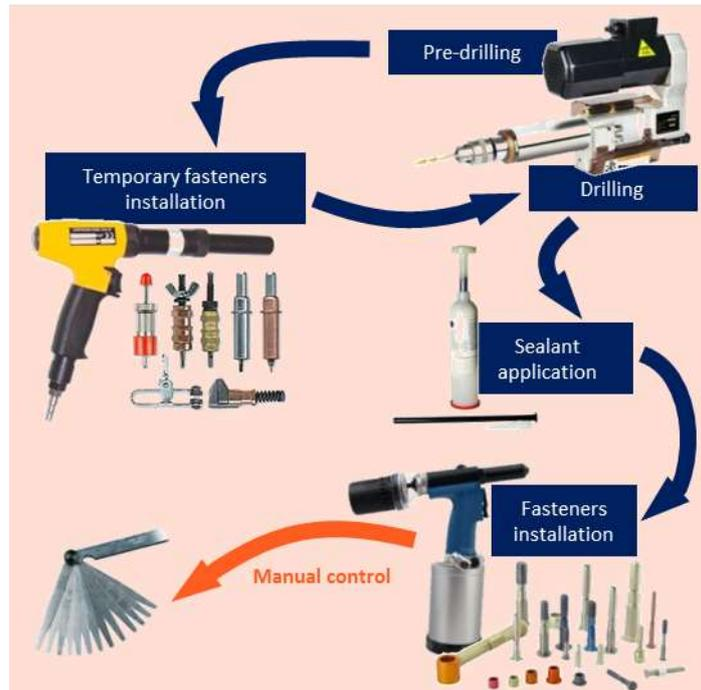
Robotisation de l'assemblage par liaisons rivetées – Opérations de perçage-rivetage (Source LISI Aerospace)
