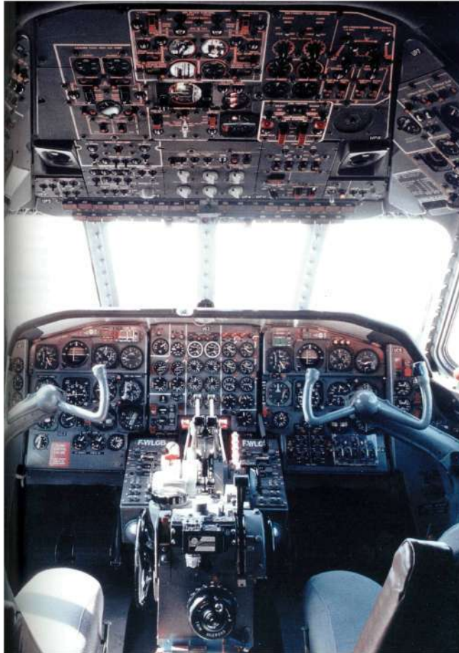
Fig. 55 poste de pilotage de la Caravelle X
