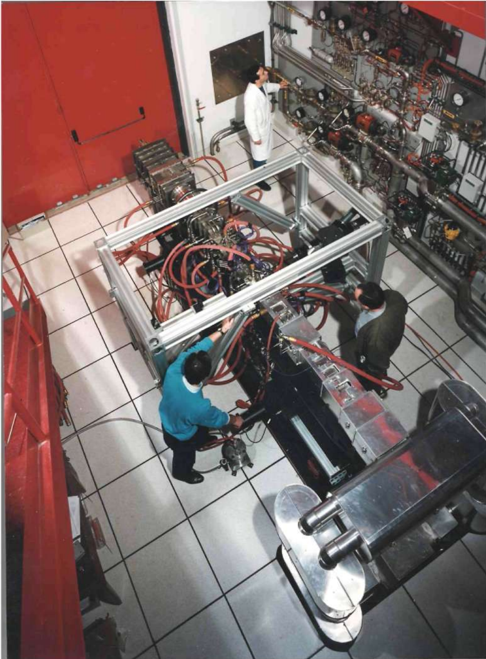
Fig. 28 Banc d'étude de la combustion de l'opération A3C au LAERTE, ONERA Palaiseau
