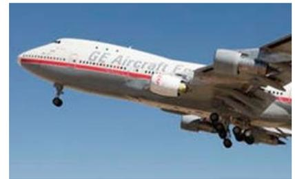
Essai en vol du LEAP
