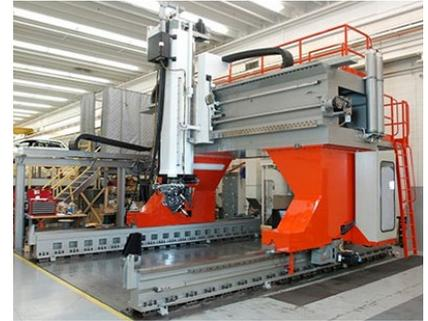
Figure 5 : Machine de soudage par procédé FSW
