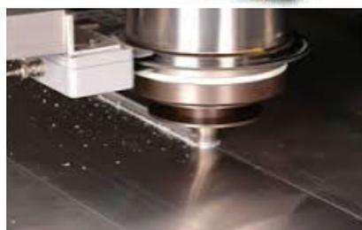
Figure 1 : Principe du soudage FSW
