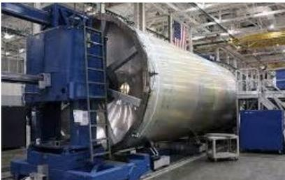
Figure 3 : Soudage d'un réservoir cryogénique (NASA)
