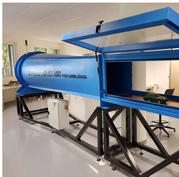
La soufflerie subsonique de l'ESTACA.
